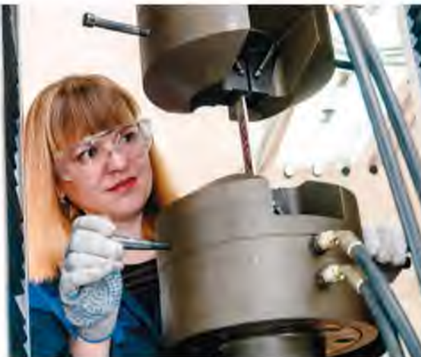
Лаборант механических испытаний Наталья Арбузова проводит испытания образцов металла на статический разрыв
